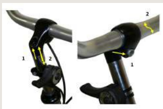
Ohjaustangon korkeuden ja kulman säätäminen
