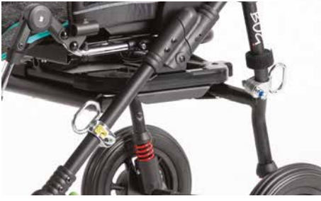
Törmäystestattu ISO7176-19 soveltuu kuljetukseen ajoneuvossa.
