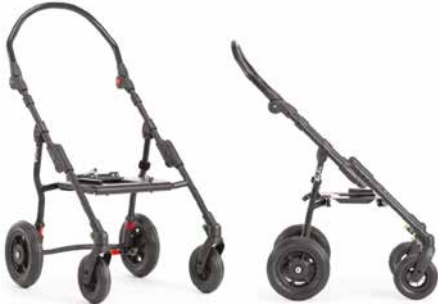
869 4-pyöräinen ulkoalusta Puhkeamattomat renkaat, suuntalukitus, rumpujarrut. Renkaat: Etu 17 cm / Taka 25 cm (S) tai 30 cm (M).
